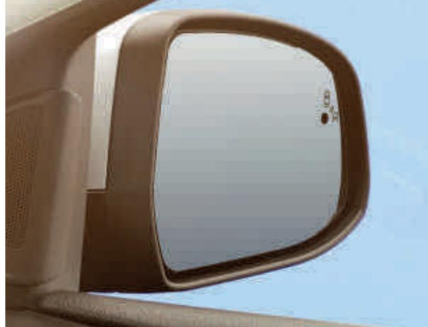
◀ Система мониторинга "слепых" зон с функцией помощи при выезде с парковки задним ходом<sup>от</sup>
