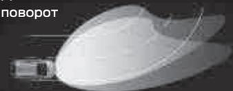
Чтобы улучшить обзор для водителей и для других участников движения, автомобили Ford Focus оборудованы адаптивными биксеноновыми фарами, которые вдвое мощнее фар традиционной конструкции, а также современными светодиодными дневными ходовыми фонарями.
